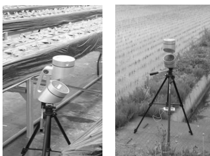
図1 エアサンプラー・MAS100を用いた空中浮遊糸状菌のサンプリングの様子（左：栽培施設内，右：屋外）
