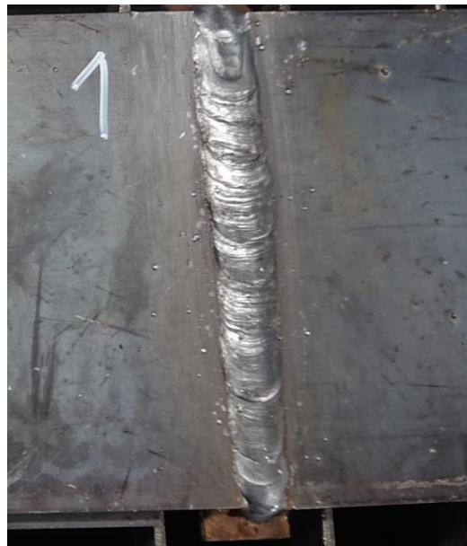
図3 溶接終了後外観(溶接ビード面拡大)
