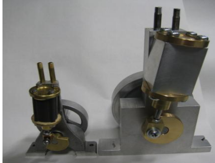
図4 市販キット（左）と本試作機（右）の対比
