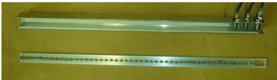
図 1 スケール（下）と近接センサ取付部（上）
