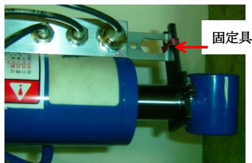
図5 スケールのシリンダロッドへの取付
