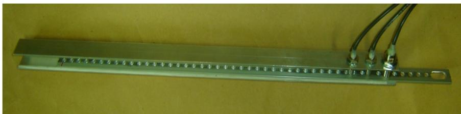
図 3 スケールと近接センサ取付部を組み合わせた状態
