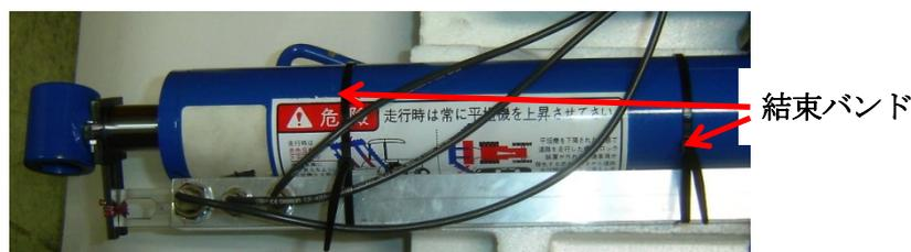
図6 検出器のシリンダへの固定
