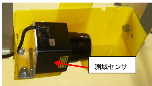
図4(c) 測域センサ取り付け箱を下から見る
