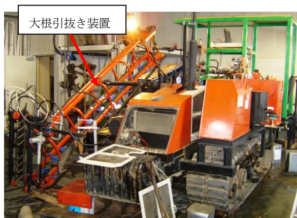
図 17 改造後のクローラ台車（前部）
