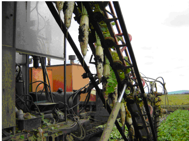
図 22 ベルトに挟まれ大根が上方に移動
