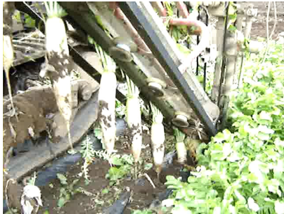
図 21 大根引き抜き装置で引き抜く
