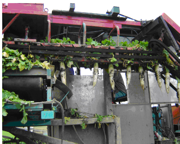
図 23 積み込み装置のコンベアまで大根が移動
