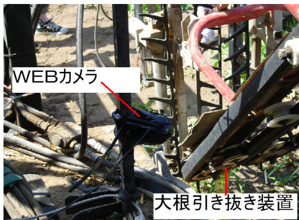
図24 WEBカメラ取り付け位置
