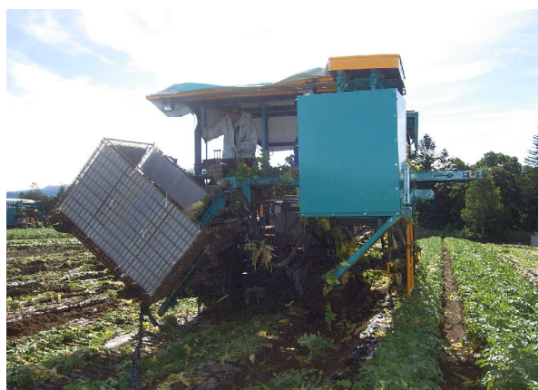
図7 (a) 自動積み込みハーベスタ後部
