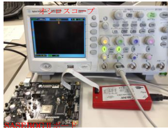
図 1. AES 回路の FPGA 実装
