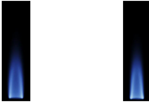
(a) Ua=0.5\text{m/s} ( FH=40\text{mm} , Q_{CO}=11.2\text{cm}^3/\text{s} ) (b) Ua=2.0\text{m/s} ( FH=40\text{mm} , Q_{CO}=11.9\text{cm}^3/\text{s} )
