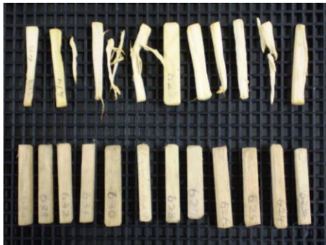
図6 木材腐朽菌 ANCT-08036 に 25℃・8 週間曝露したシラカンバ木片(上段：コントロール区；下段：固定化トリコデルマ ANCT-05013 区)
