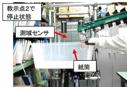
図 35 (d) 測域センサの真下に紙筒を置く
