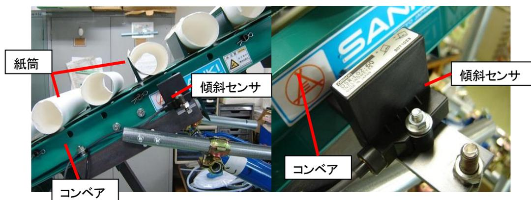
図 34 傾斜センサの取り付け
